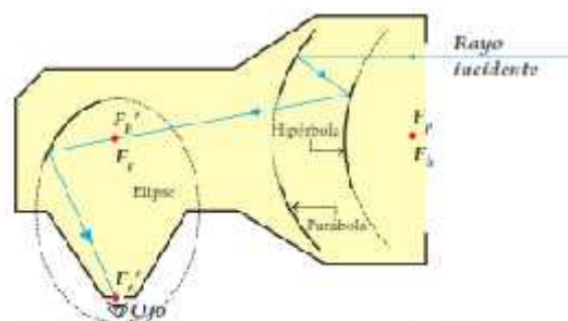
Propiedad de las tres cónicas utilizadas en el diseño de un telescopio.
