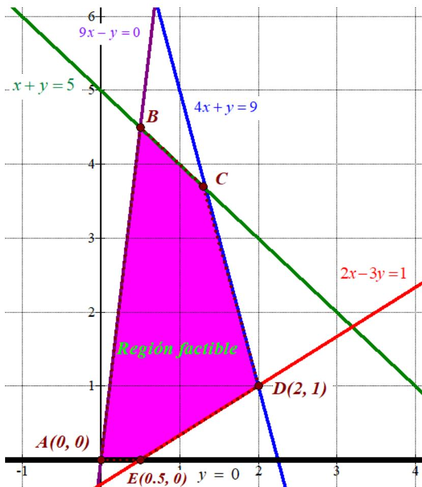
Nos falta determinar las coordenadas de los vértices B y C.
